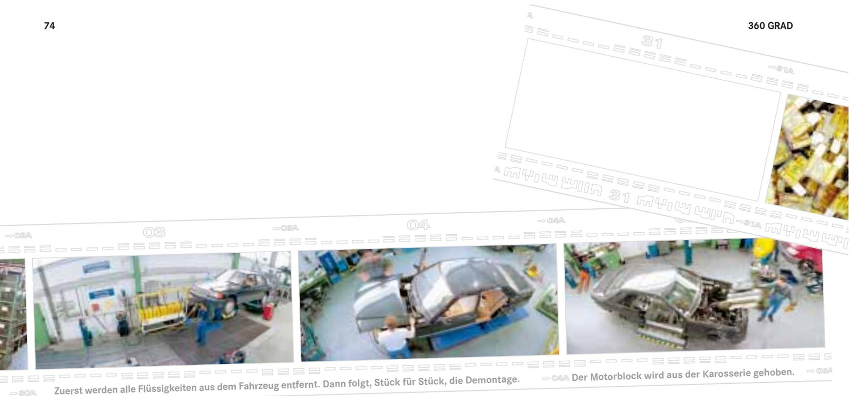
Zuerst werden alle Flüssigkeiten aus dem Fahrzeug entfernt. Dann folgt, Stück für Stück, die Demontage.
