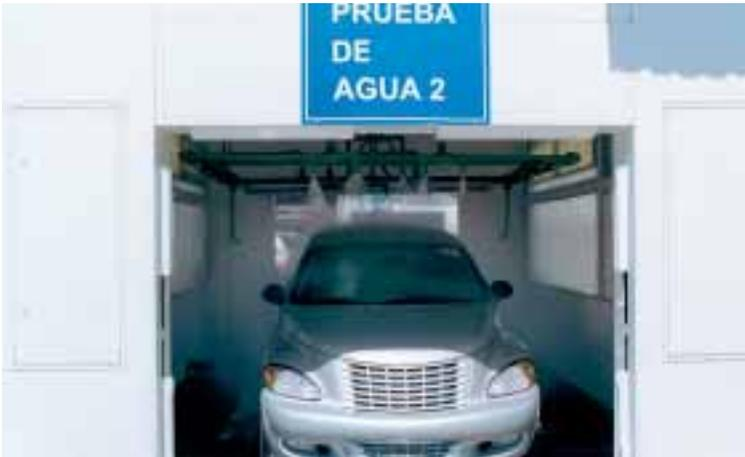
Ein Chrysler PT Cruiser wird gewaschen, um ihn auf Lackschäden zu untersuchen.
