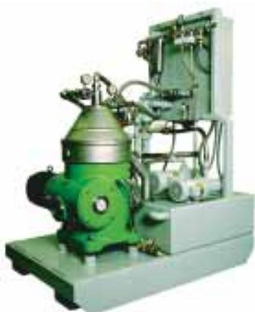
Zentrifuge zur Aussonderung von Verunreinigungen aus Kühlfüssigkeiten.
